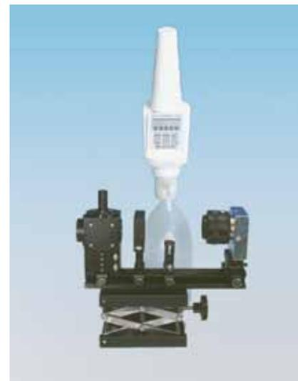
Abb. 18 Gerät zur Messung der Tropfeneinsinkzeit
