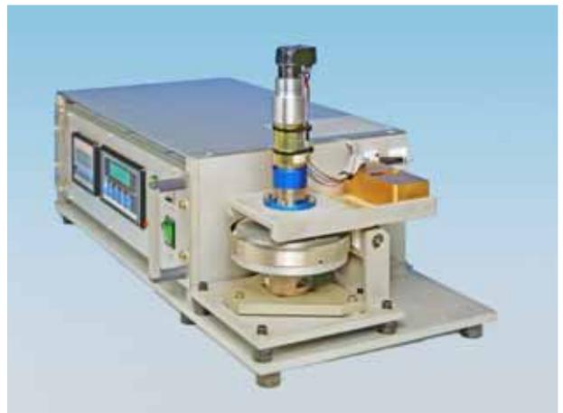
Abb. 08 ... und nochmals der Rotations - Wischsimulator im Gebrauchszustand
