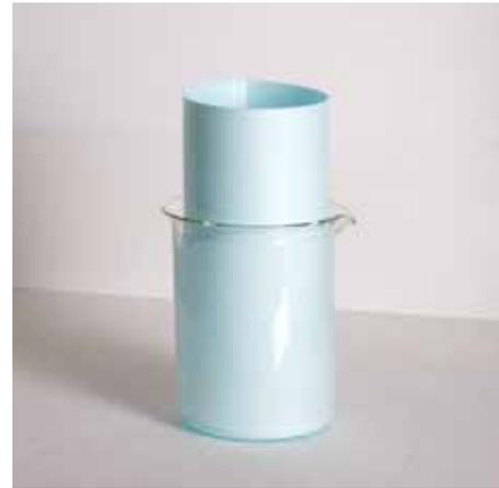
Abb. 20 Tauchen eines geformten Papiers in eine Prüflüssigkeit
