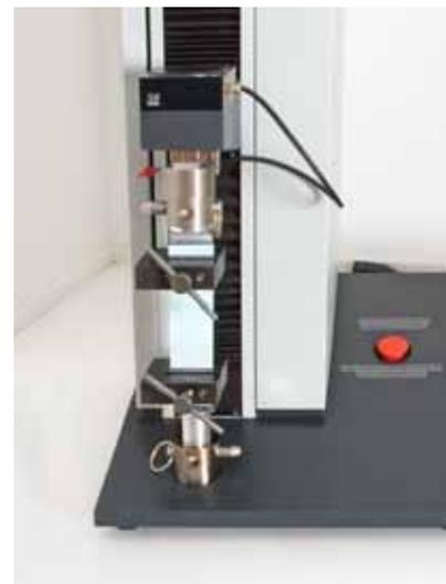
Abb. 03 Höchstzugkraft- / Dehnungs-Messgerät, Adamel
