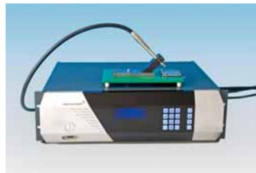
Abb. 37 Kontavisor, Systekum GmbH, Kiel Laser-Fluoreszenz-Dickenmessung dünner Ölschichten
