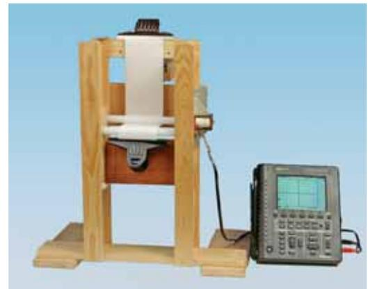
Abb. 27 Triboelektrik - Fallschlitten nach Ehrler und Oszilloskop
