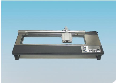
**Abb. 1** Linear-Wischsimulator II nach Labuda
