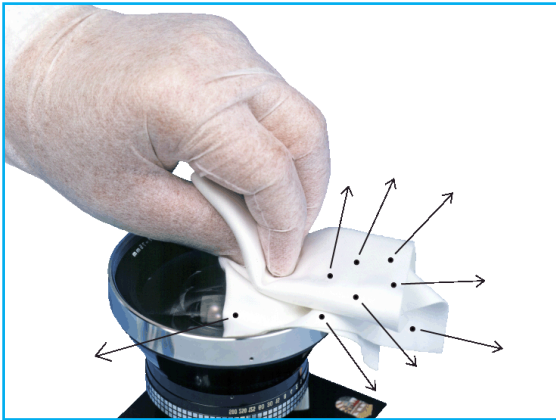
Abb. 10 Partikelfreisetzung in die Umgebung hinein durch Knüllen und Bewegen (Walken)
