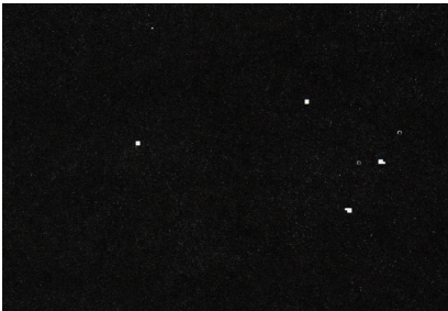
Abb. 6 Kollektor-Platte nach dem Reinigen - gesehen vom elektronischen Bildanalyseprogramm. Nach dem Reinigungsvorgang verbleiben 4 Partikel im aktiven Kollektorabschnitt. Sie werden auf dem Bildschirm des Monitors und in der Diagrammregisterkarte 10 übersichtlich dargestellt. Die Anzahl der auf der Kollektorplatte verbleibenden Partikel ist der „Grauwert“, der nach ordnungsgemäßer Verwendung des Kollektors von der Partikelanzahl abgezogen wird. Der untersuchte Abschnitt der Kollektorplatte für Abb. 6, 7 und 8 betrug 9 \times 5,8\text{ mm} .
