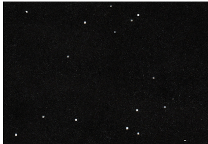
Abb. 7 Reinraumtuch - In diesem Fall wurde der Partikel-Kollektor 5 Sekunden lang auf die Oberfläche eines Reinraumtuches gedrückt und anschließend durch die elektronische Bildanalyse ausgewertet. Deutlich mehr Partikel (37 Stück) als auf dem nebenstehenden Bild befinden sich auf der Kollektorplatte. Aufgrund der Platzverringerung für dieses Bild sind nicht alle im Diagramm 10 erscheinenden Partikel hier zu sehen.
