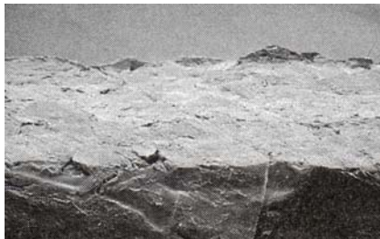
Abb. 20 Das Papier 5 zeigt einen optimalen Kantenbeschnitt, welcher in seiner Güte Papier 4 noch übertrifft, dies aber nur an 3 Kanten von 4.
