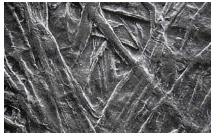
Abb. 8 Papier 5 - homogene Faserverteilung, ausreichende Glätte
