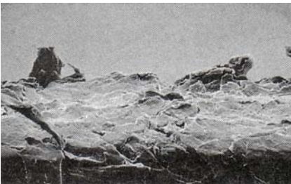
Abb. 19 Kante von Papier 4 hebt sich in ihrer Glätte positiv von den bisher untersuchten Papieren ab.
