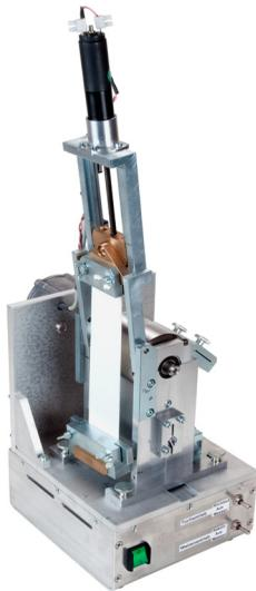
**Abb. 8** Labuda-Rotations-Wischsimulator Mk III in der Ausgangs-Stellung.
