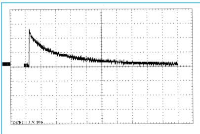
**Abb. 14** Vergleich zu Abb. 13: Ladungsdiagramm, Gestricke aus PES, angefeuchtet mit DI-Wasser (keine Ladung, 0 V : 0 s)
