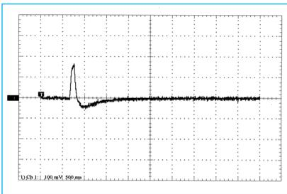
**Abb. 12** Vergleich zu Abb. 11: Ladungsdiagramm, Gestricke aus PES, gewaschen und nichtionisch ausgerüstet (+530 V : 188 ms / - 149 V : 1,6 s) (Maßstab 10-fach vergrößert)
