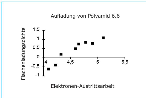
**Abb. 2** R. G. Arridge hat 1967 dieses bekannte Diagramm der Flächenladungsdichte in Elementarladungen pro Flächeneinheit relativ zur Elektronenaustrittsarbeit verschiedener Metalle WM aufgezeichnet. Daraus kann angenommen werden, daß z. B. die Elektronenaustrittsarbeit für Polyamid 6.6 bei etwa 4,4 eV liegt.
