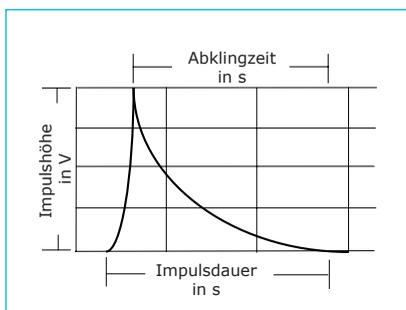
**Abb. 7** Ladungsdiagramm, wie es sich beim Betrieb des Fallschlittens nach Ehrler auf dem Speicheroszilloskop abbildet
