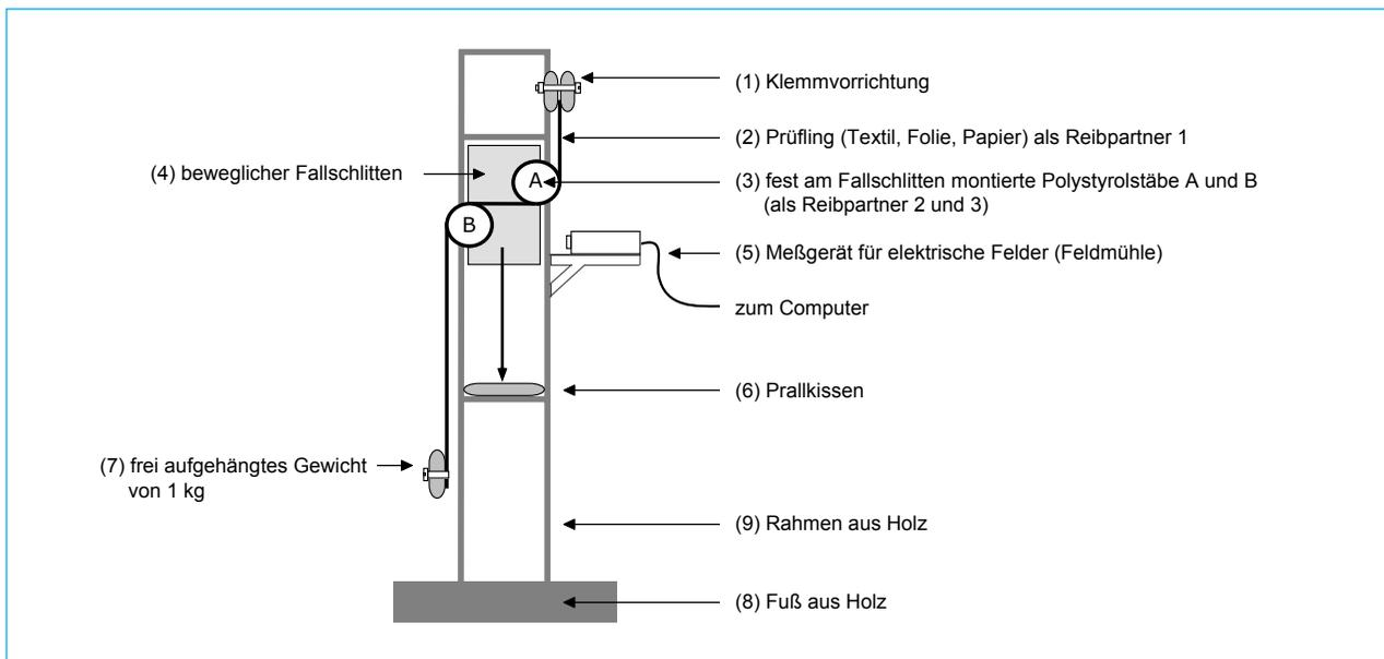
**Abb. 10** Fallschlitten nach Ehrler zur Messung der Triboelektrizität von porösen Flächengebilden, Schemazeichnung
