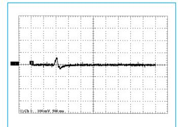
**Abb. 18** Ladungsdiagramm, das gleiche Papier wie in Abb. 17, jedoch nach kurzem Tauchen in 0,1%ige NaCl-Lösung und Trocknung (+ 181 V : 171 ms)
