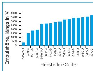
**Abb. 23** Prüfergebnisse für die Impulshöhe diverser Reinraum-Vliesstoff-Tücher nach Reibung in Längsrichtung
