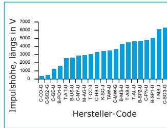
**Abb. 19** Prüfergebnisse für die Impulshöhe diverser Reinraum-Gestricke-Tücher bei Reibung in Längsrichtung
