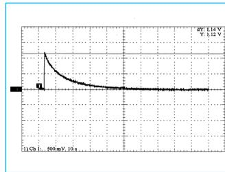
**Abb. 15** Ladungsdiagramm, Vliesstoff-Tuch aus 50:50 PES-Cellulose (+3876 V : 62,1 s)
