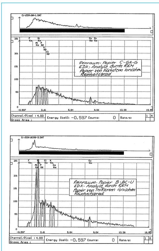
**Abb. 6** Auswertungen mit der energiedispersiven Röntgenanalyse (EDX)
