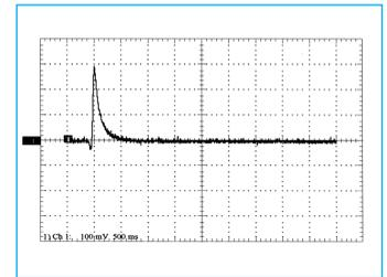
**Abb. 16** Ladungsdiagramm, das gleiche Material wie Abb. 15, aber Hälfte des Prüflings naß (+938 V : 750 ms) (Maßstab 5-fach vergrößert)
