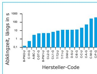
**Abb. 25** Prüfergebnisse für die Abklingzeit diverser Reinraum-Vliesstoff-Tücher nach Reibung in Längsrichtung
