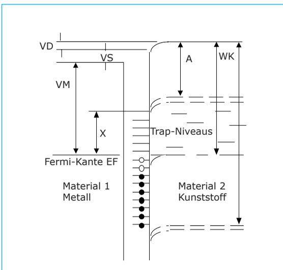
**Abb. 1** Energieschema des Ladungsträger-Übergangs nach Bauser. Bedeutung der Indices:
