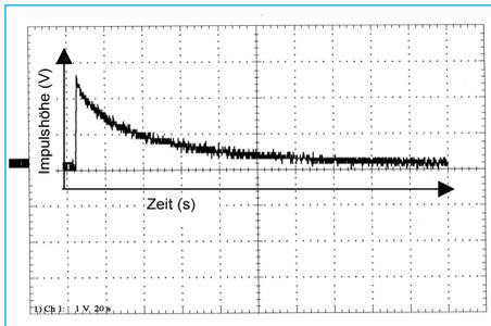
**Abb. 4** Ladungsdiagramm eines Reinraumtuchs im Trockenzustand (Methode Fallschlitten nach Ehrler)
