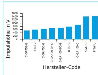
**Abb. 27** Prüfergebnisse für die Impulshöhe diverser Reinraum-Papiere
