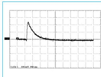
**Abb. 17** Ladungsdiagramm, Standard-Reinraum-Papier mit Polymer-Beschichtung (+796 V : 1,43 s)
