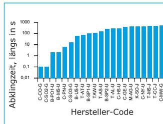
**Abb. 21** Prüfergebnisse für die Abklingzeit diverser Reinraum-Gestricke-Tücher nach Reibung in Längsrichtung
