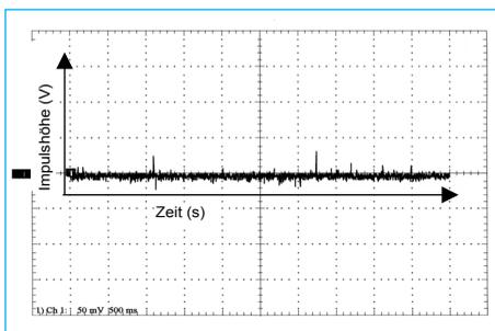
**Abb. 5** Ladungsdiagramm des gleichen Reinraumtuchs im Feuchtzustand (Methode Fallschlitten nach Ehrler)
