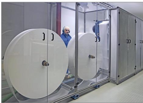
Abb. 13 1991: Fertigung von Interfold-Tüchern für Spender-, Einhand- und Einzeltuch-Entnahme.
