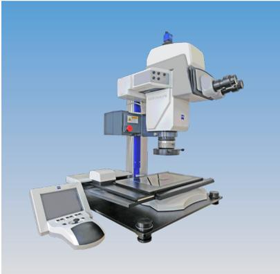
**Abb. 56** Automatisiertes Lichtmikroskop Axio Zoom.V16 mit Fluoreszenz-, Pol-, Differentieller Interferenz und Phasen-Kontrast für Durch- und Aufsicht-Beleuchtung.
