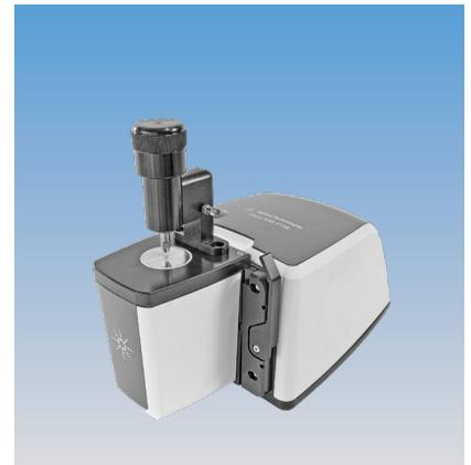
**Abb. 55** FTIR-Spektrometer.
