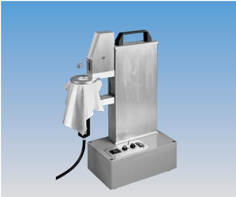
**Abb. 27** Fallkugel-Prüfgerät nach Labuda (1987) für die Partikelfreisetzung aus textilen Flächen-Gebilden.
