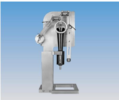
**Abb. 35** Walk-Simulator MK I nach Schöttle/Labuda zur Bestimmung der Partikel-Freisetzung.
