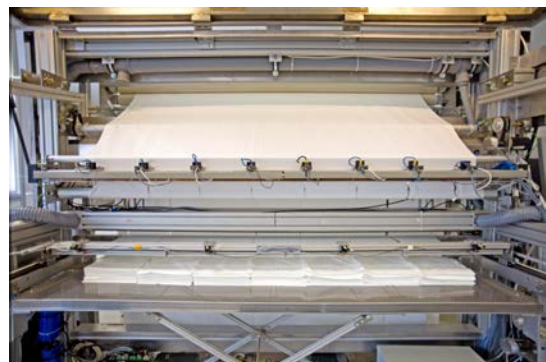
Abb. 13 Formatier- und Legestation mit automatischer Tuchablage und Laser-Formatierung
